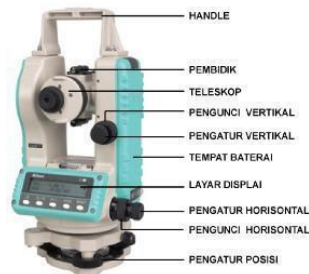
Gambar 4.4 Komponen pada Theodolite Digital.
