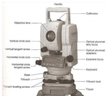
Gambar 4.5 Komponen pada Total Station .
