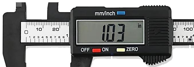
**Gambar 13.** Skala Jangka Sorong Digital
