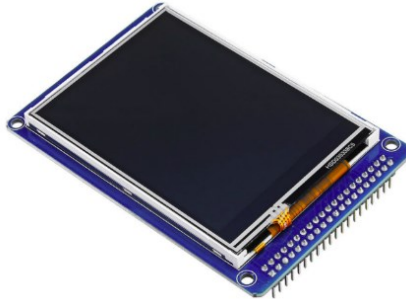
Gambar 2. 4 Modul LCD Arduino Mega 2560
