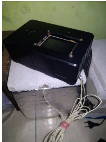
Gambar 4. 7 Alat uji koefisien serap panas
