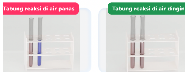
Gambar 4.3 Perbandingan perubahan warna larutan pada tinggi panas dan suhu rendah
