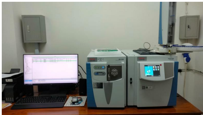
Gambar 2.2 Gas Chromatography-Mass Spectrometry (GC-MS) Thermo Scientific ISQ 7000 dengan tipe GC TRACE 1300-1310. (Dokumen pribadi, 2022)
