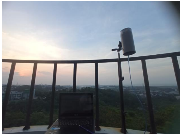
Gambar 3.22 Pemasangan SQM yang diarahkan ke zenith
