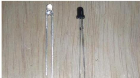
Gambar 2. 2 Sensor inframerah
