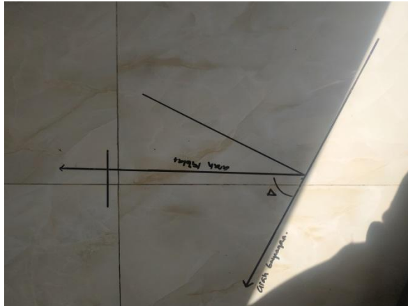
Gambar 4.3: Hasil perhitungan arah kiblat Masjid Baiturrahman Robayan menggunakan metode qiblat tiap saat
