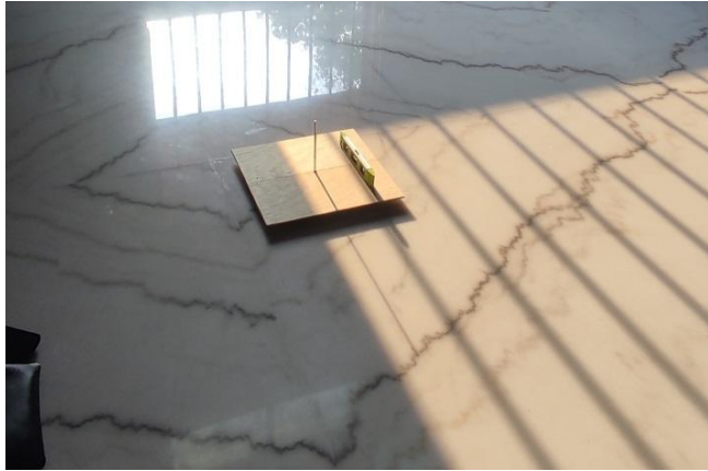
Gambar 3.5: pengecekan menggunakan metode raşdul qiblat global
