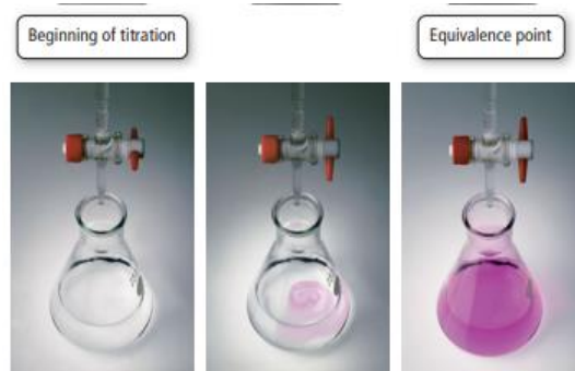
Gambar 2.2 Larutan Titrasi Sebelum Mencapai Titik Ekuivalen (Kiri), Setelah Mencapai Titik Ekuivalen (Kanan)
