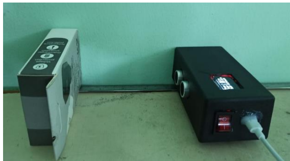
Gambar 4. 5 Pengujian Jarak Sensor Ultrasonik HC-SR04 untuk Jarak X
