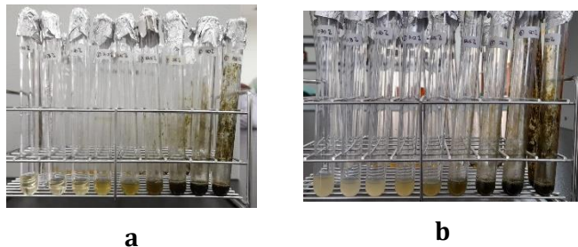
Gambar 4. 12 Hasil Uji KHM dari Kiri ke Kanan dengan Konsentrasi 0,39% hingga 100% (a) Sebelum Inkubasi; (b) Setelah Inkubasi
