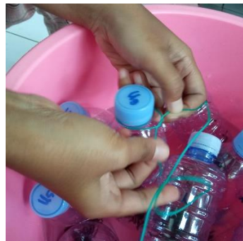
Gambar 8. Pemasangan tali ris pada botol
