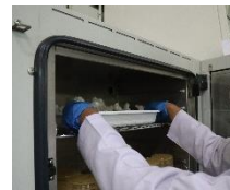
penginkubasian sampel pada suhu 35-36 °C selama 24 ± 2 jam
