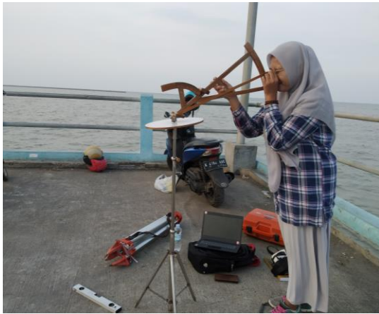
Gambar 4. 4 Penentuar arah kiblat menggunakan backstaff pada 21 Mei 2023 pukul 16.37 WIB
