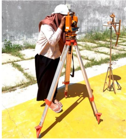
Gambar 4. 6 Penentuan arah kiblat menggunakan theodolite pada Jum'at tanggal 26 Mei pukul 10.53 WIB
