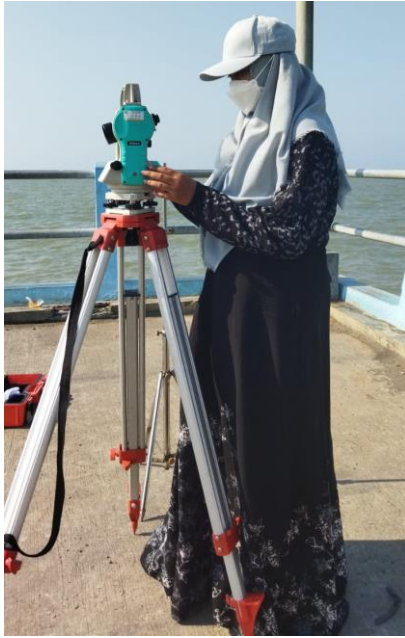
Gambar 4. 3 Penentuan arah kiblat menggunakan theodolite
