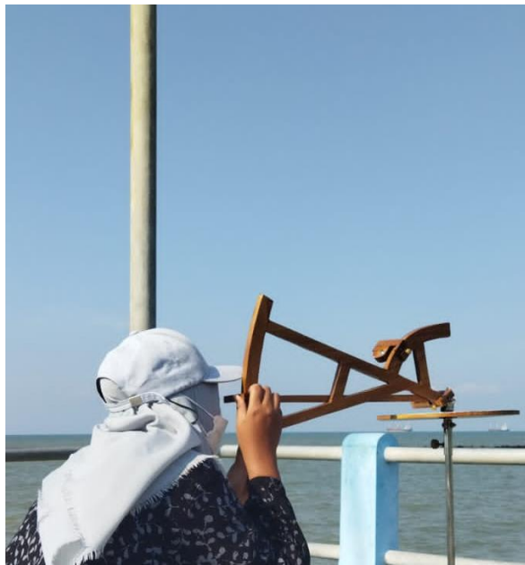
Gambar 4. 1 Pembidikan tinggi Matahari menggunakan backstaff
