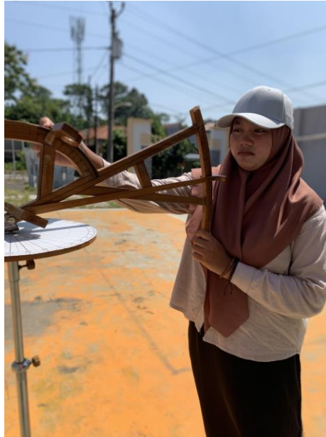
Gambar 4. 10 Penentuan arah kiblat menggunakan backstaff
