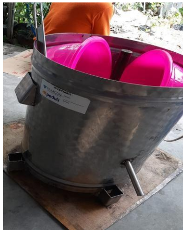
Mesin spinner untuk mengeringkan daging ikan lele
