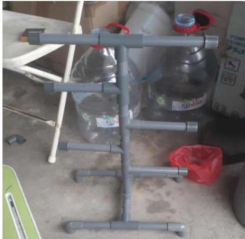
Penyangga diperkuat dengan menggunakan pipa
