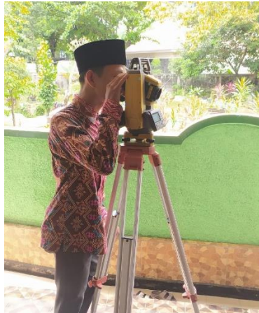
Gambar 3.9 Proses pengukuran arah kiblat dengan menggunakan alat bantu theodolite
