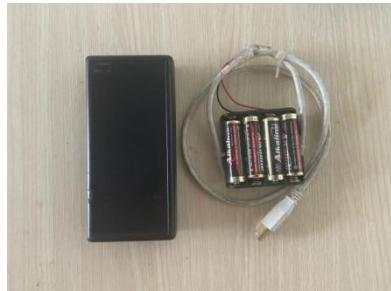
Gambar 3. 8: SQM dan baterai yang sudah terpasang kabel USB
