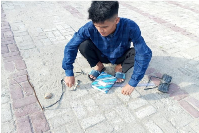
Gambar 3.4. Proses pengukuran dengan Rashdul Kiblat
