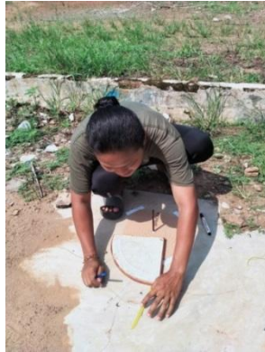
Gambar 3. 3 Pengukuran Arah Kiblat Dengan Alat Rubu' Mujayab
