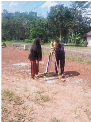
Gambar 3. 4 pengukuran arah kiblat Masjid Al-Mukhlis menggunakan alat Theodolit
