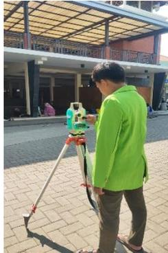
Gambar 3.7: Menentukan arah kiblat menggunakan Tehodolite
