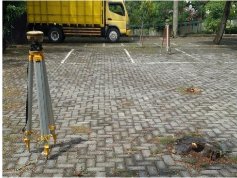
Gambar 4. 3 Pengamatan Menggunakan GPS Geodetik pada 21 Maret 2023 di Masjid Kampus 3 UIN Walisongo Semarang
