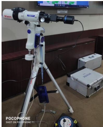
CCD dipasang Teleskop
