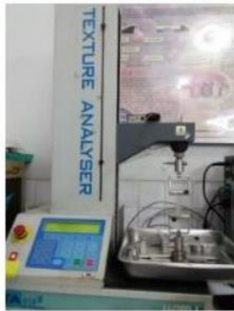
Gambar 2. 13 Alat Uji Kuat Tarik (Rojtica, 2021).
