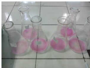
Uji asam lemak bebas biodiesel
