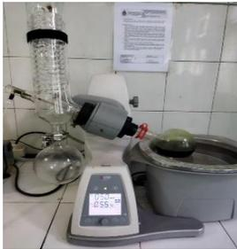
Proses penguapan pelarut menggunakan *rotary evaporator*
