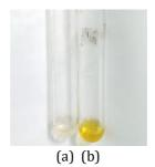
**Gambar 4. 7** Uji Flavonoid (a) sebelum uji flavonoid, (b) setelah uji flavonoid
