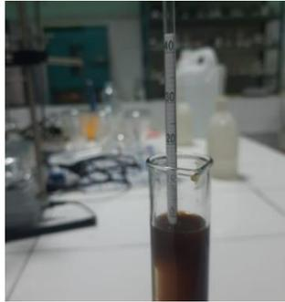
Gambar 4. 11 Uji kadar alkohol menggunakan alkoholmeter EE-1
