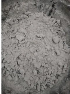
Gambar 4.8 Paving Block 50% Abu Serbuk Kayu Jati, 20% Semen, dan 30% LDPE
