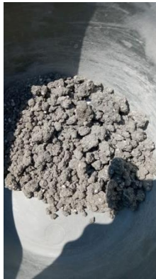
Gambar 4.6 Paving Block 30% Abu Serbuk Kayu Jati, 20% Semen, dan 50% LDPE
