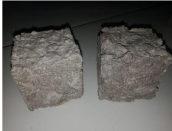
Gambar 4.5 Paving Block 50% Abu Serbuk Kayu Jati dan 50% LDPE
