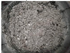
Gambar 4.7 Paving Block 40% Abu Serbuk Kayu Jati, 20% Semen, dan 40% LDPE
