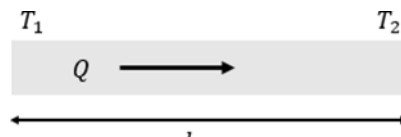
Gambar 2. 2 Parameter penentu perpindahan panas secara konduksi
