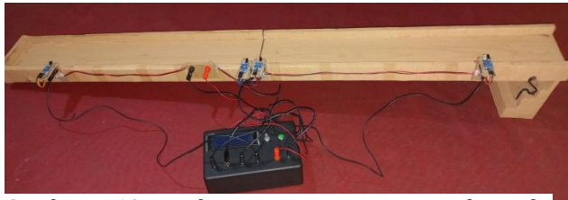
Gambar 4. 13 Rangkaian pengujian sensor infrared module untuk mendeteksi waktu tempuh
