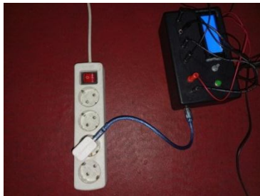
Gambar 8 Hubungkan box LCD dengan stopkontak
