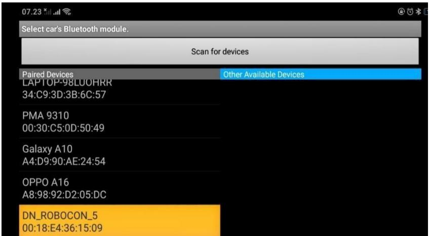
Untuk mengconnect kan *Bluetooth RC Controller* sebagai *Remot Control* pada media harus disambungkan dengan *bluetooth* pada *handphone*, dan memilih seperti pada gambar diatas (DN\_ROBOCON\_5)
