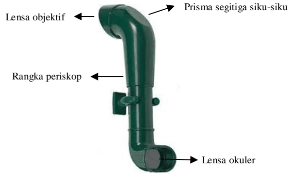
Gambar 2. 13 Bagian-bagian Periskop
