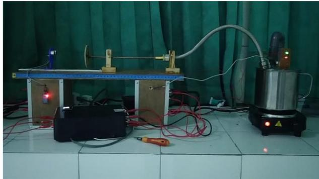
Gambar 2.1 Prototipe alat praktikum koefisien muai panjang
