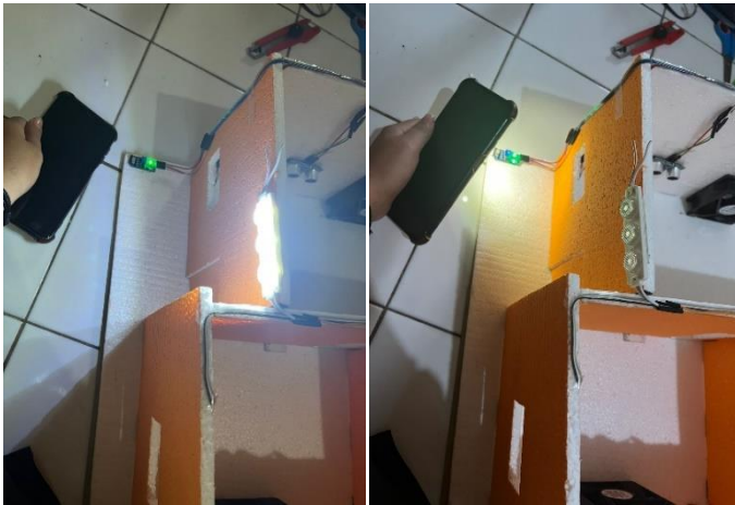
Gambar 4. 1 Pengujian Sensor LDR
