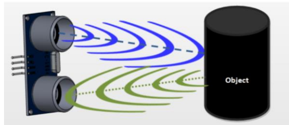
Gambar 2. 8 Ilustrasi Prinsip Kerja Sensor Ultrasonik
