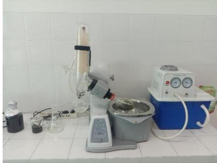
d. Proses ekstraksi menggunakan *Rotary evaporator*
