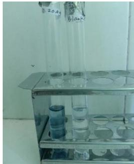
e. Pembuatan larutan blanko dan asam galat untuk mengukur panjang gelombang
