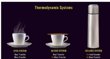
Gambar a. contoh sistem terbuka, b. sistem tertutup dan c. sistem terisolasi
