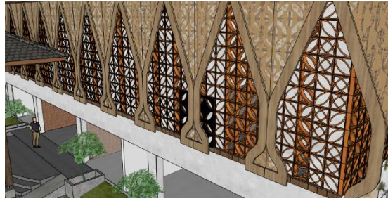
Gambar 5. 1 penerapan roster Pada bangunan
