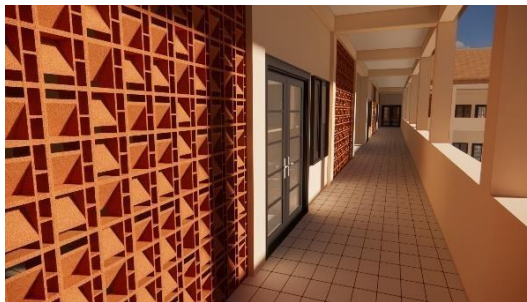
Gambar 5. 7 Material rooster pada fasad bangunan
