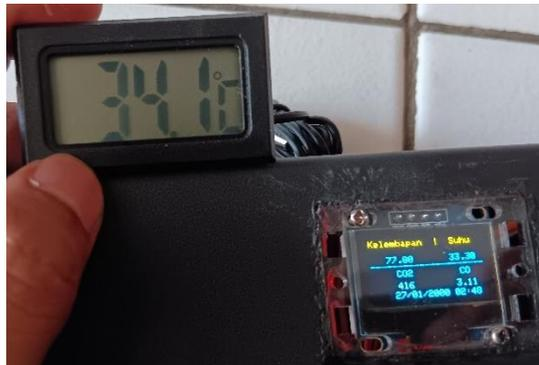
*Gambar 4.6 perbandingan kelembapan sensor DHT22*
