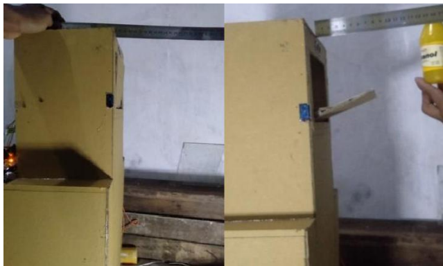
Gambar 4.24 Pengujian Sensor Ultrasonik dan Motor Servo
