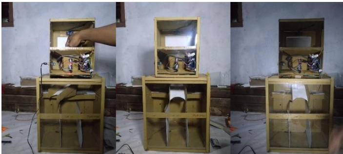
Gambar 4.26 Pengujian Sensor Ultrasonik, Proximity Induktif & kapasitif dan Motor.Servo
