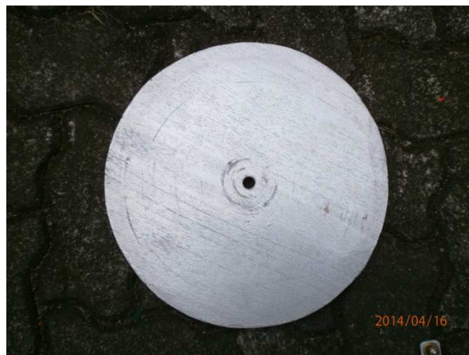
Gambar 3.3 Bidang Dial Qibla Laser Dengan Diameter 29 cm
