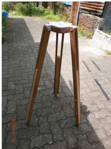
Gambar 3.2 Tripod Qibla Laser Dengan Menggunakan Kayu dan Panjang 1 Meter
