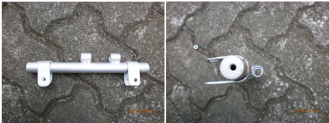
Gambar 3.7 Lubang Pengintai Qibla Laser Dengan Panjang 12 cm dan Dilengkapi Dengan 2 Lingkarang di atasnya Untuk Menempatkan Laser.
