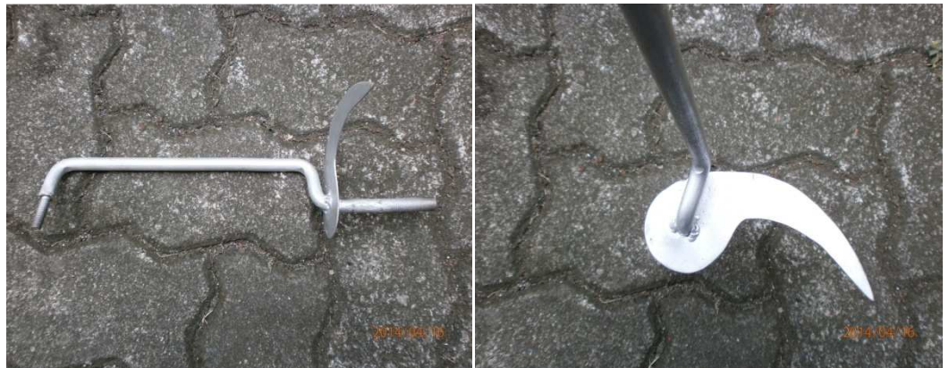
Gambar 3.5 Mounting Qibla Laser Dengan Panjang 25 cm dan Penanda Derajat Dengan Bentuk Seperti Sabit.
