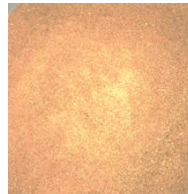
Selulosa setelah proses bleaching, di oven, lalu di haluskan.
