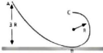
Kelereng bermassa  $m$  diletakkan di titik A sehingga bergerak menuruni permukaan lintasan licin. Jika percepatan gravitasi  $g$  kecepatan di titik C sebesar ....m/s
