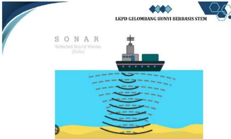
Gambar 13 Ilustrasi pengukuran kedalaman laut menggunakan sonar
