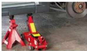
Gambar 2.1 Mobil terangkat dengan bantuan dongkrak hidrolik
