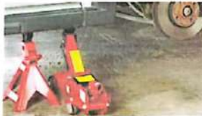
Gambar 2.1 Mobil terangkat dengan bantuan dongkrak hidrolik
