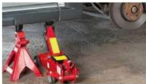
Gambar 2.1 Mobil terangkat dengan bantuan dongkrak hidrolik
