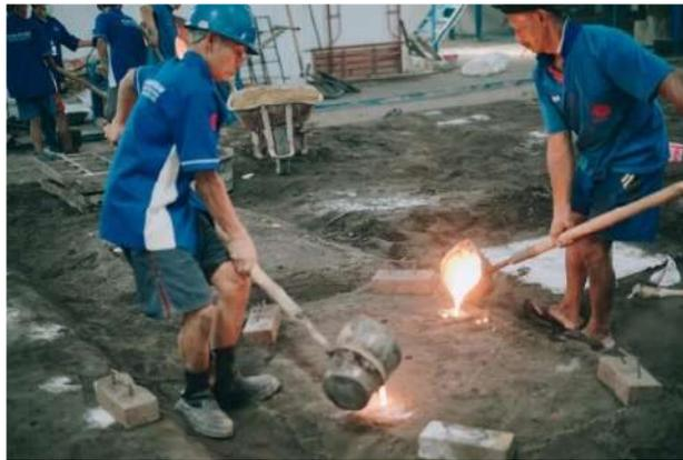
Gambar 32. Pengecoran Logam. Sumber: ensiklopediajawatengah.com
