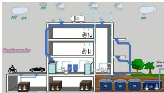
**Gambar 4.27** ilustrasi sistem air hujan
