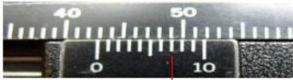
Gambar 2.4 Pembacaan skala jangka sorong Sumber : (Abdullah, 2016)
