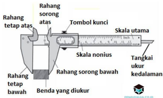
Gambar 2.3 Bagian-bagian jangka sorong (Sumber: https://images.app.goo.gl/2d2PZJ8oYS4KZf8z7 )
