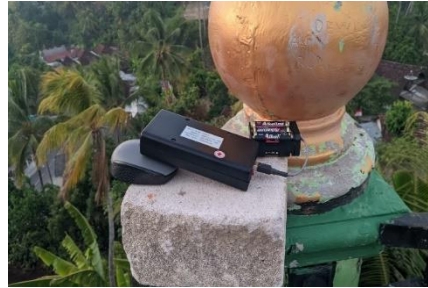
Gambar 3. 22 Pemasangan Adaptor atau Baterai Pada SQM
